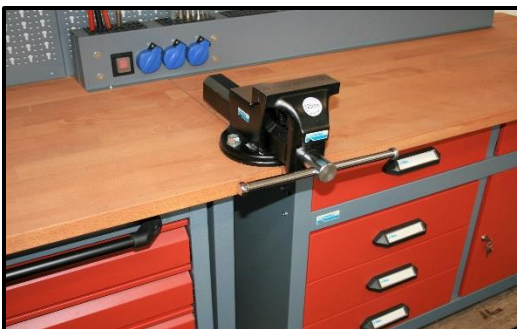
Montage zwischen 2 Werkbänken Mounting between 2 workbenches
